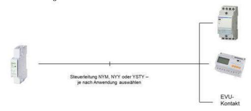
Option 2: Verbrauchsgerät hat <u>keine</u> digitale Schnittstelle → Freigaberelais + Steuerleitung installieren
